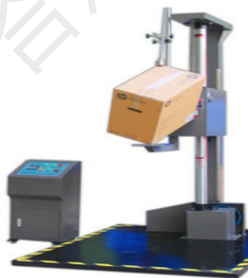
图 4 包件跌落试验示意图
