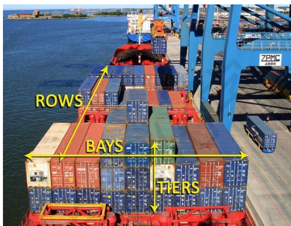
图 1 集装箱三位坐标示意图
