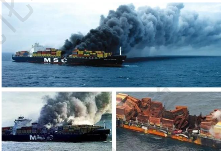
图1 二乙烯基苯发生聚合反应引起爆炸
